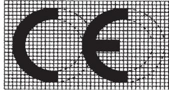
2. Bei Verkleinerung oder Vergrößerung der CE-Kennzeichnung sind die sich aus dem oben abgebildeten Raster ergebenden Proportionen einzuhalten.
